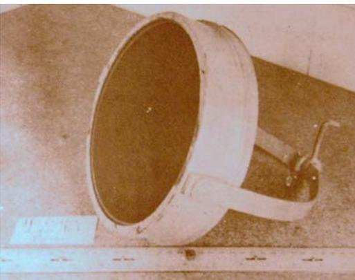
*Nachtfahrgerät infra-red filter for the headlights.*
